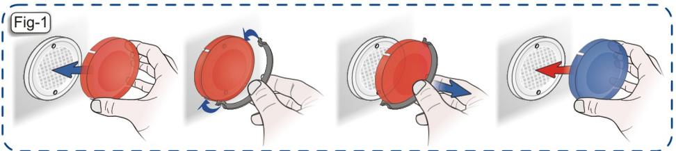
La lámpara halógena puede cambiarse desde el interior del SPA desenroscando el embellecedor tal como se muestra en la Fig.2.
